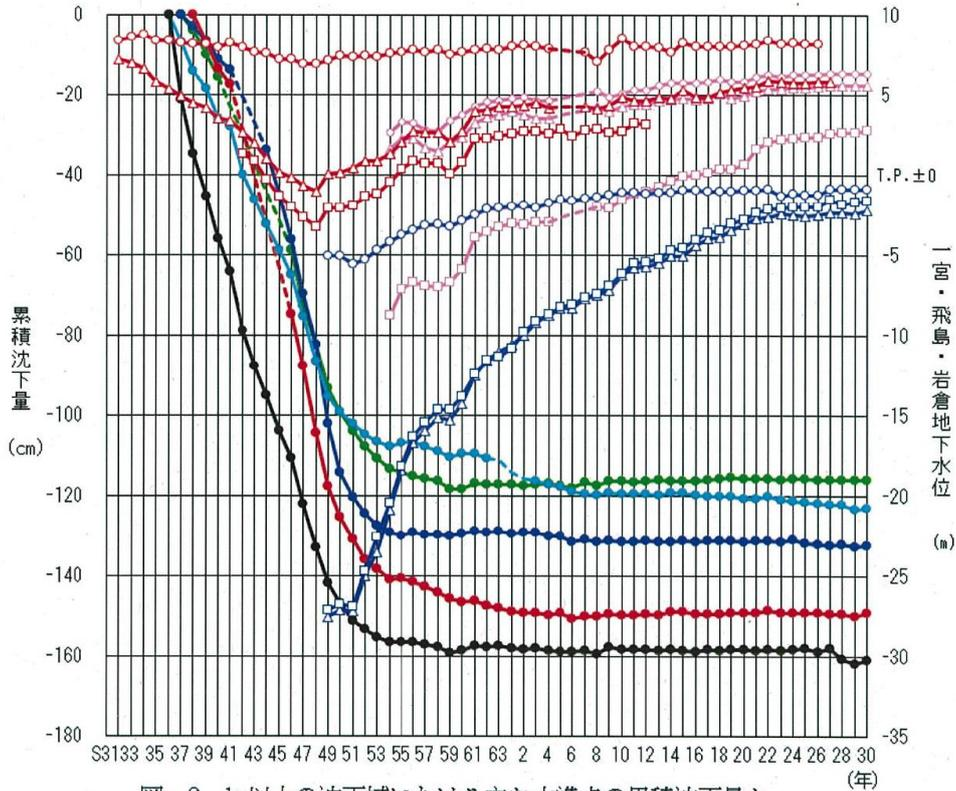
図-6 1m以上の沈下域における主な水準点の累積沈下量と地下水観測所の年平均地下水水位の経年変化
