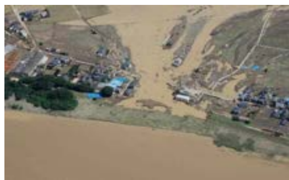
堤防決壊による家屋の流失(鬼怒川)
