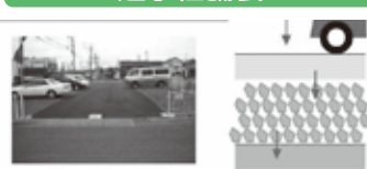
透水性舗装は雨水を地下にしみこませることができます。駐車場などでは、なるべく舗装しないことが流出制御に効果があります。
