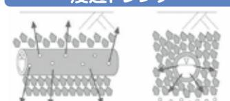
浸透トレンチは排水管に穴が開いていて、雨水を地下に染み込ませることが出来ます。
