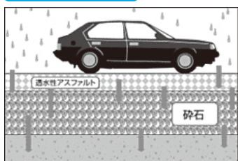
雨水がアスファルトを通して、碎石や砂の間に貯留され、地中にしみこみます。
